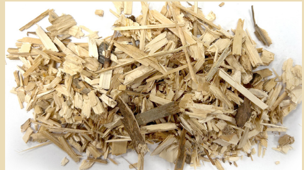
Sehr feines P16B (G30) Hackgut für Pyrolysebetrieb weniger geeignet.
