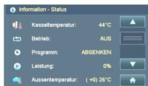
**Informazioni stato** → Visualizzazione stato caldaia
