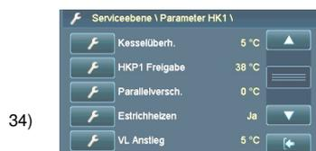
34) Impostazione isteresi caldaia → viene sommata alla temperatura nominale della caldaia
