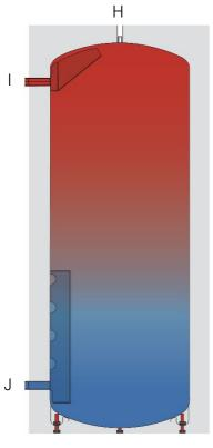
H = Entlüftung 1/2" I = Heizungsvorlauf 5/4" J = Heizungsrücklauf 5/4" (Entleerung)
