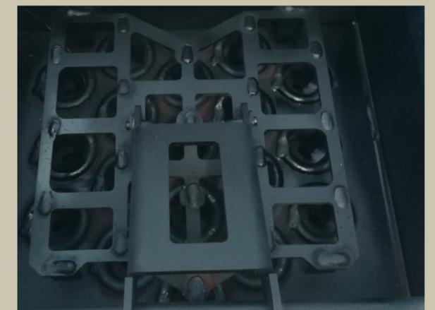
**WÄRMETAUSCHER:** Niedertemperatur-Wärmetauscher neigen zur Kondensatbildung, was die Effizienz senkt und die Lebensdauer der Kessel verkürzt. Unser speziell entwickeltes Einspritzsystem verhindert diese Kondensatbildung und sichert auch langfristig den problemlosen und hocheffizienten Betrieb.
