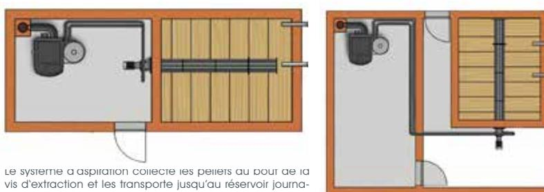
Le système à aspiration collecte les pellets au bout de la vis d'extraction et les transporte jusqu'au réservoir journalier.
