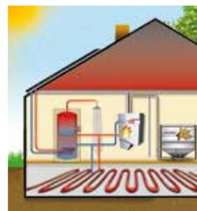
Schéma avec chaudière murale à granulés de bois THERM, système ballon tampon, installation solaire, réservoir à granulés de bois intérieur, circuit de chauffage et eau chaude sanitaire
