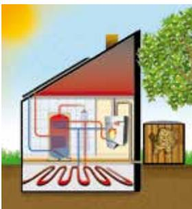
Schéma avec chaudière murale à granulés de bois THERM, ballon E.C.S., installation solaire, silo à granulés de bois extérieur, circuit de chauffage et eau chaude sanitaire
