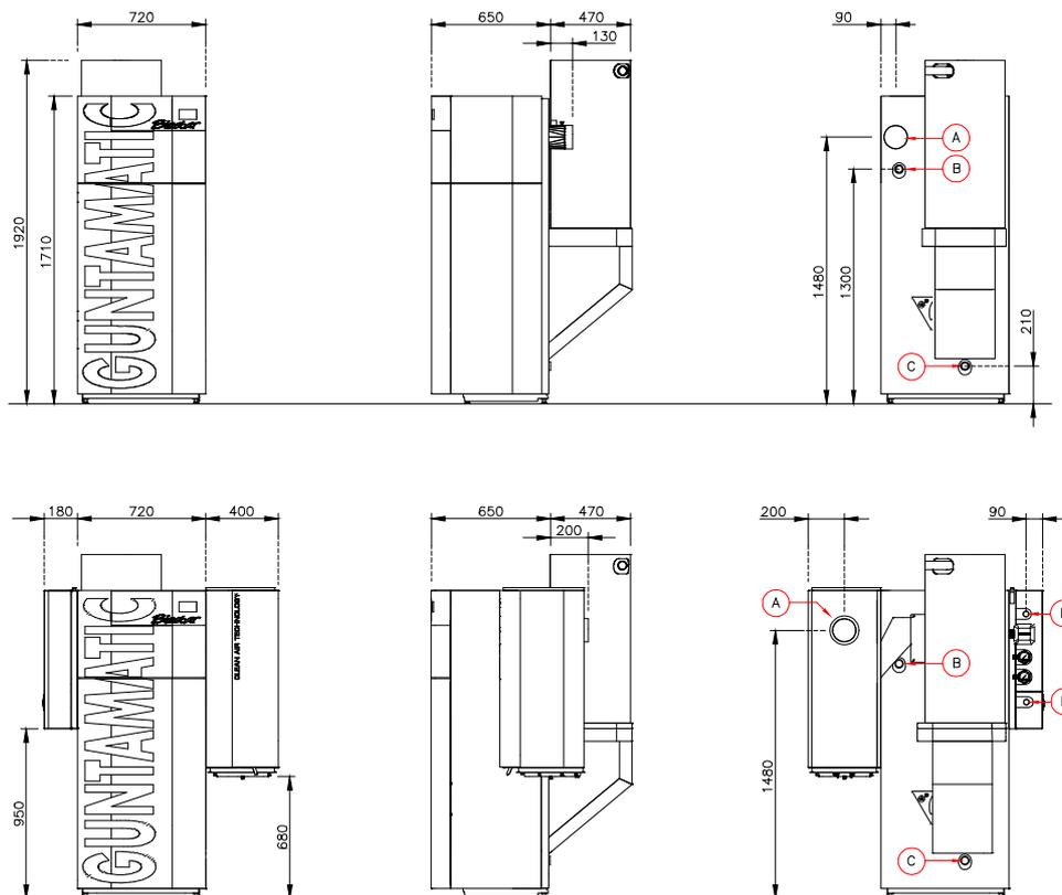
Variante mit angebautem EC-Filter und Mildhybrid Modul
