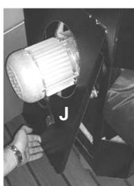
11) Débranchez le ventilateur d'extraction (I). Soulevez et retirez ensuite la tôle d'habillage (J). Dévissez les écrous papillons derrière celle-ci, retirez le ventilateur d'extraction (K) et vérifiez que la turbine ne soit pas encrassée. Soulevez la tôle de centrage RRK (L) et retirez-la.
