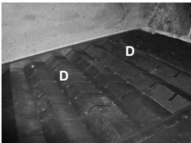
4) Enlever proprement les résidus de combustions sur les fentes d'aération (D) de la grille à l'aide d'un petit objet plat tel que par. ex. un petit tournevis (E).
