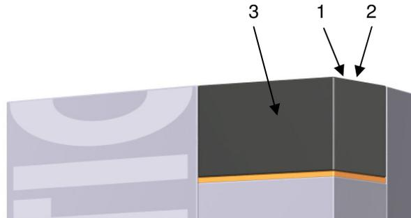
Interrupteur réseau (1) Reste normalement toujours sur I. Il n'est permis de mettre l'interrupteur réseau sur 0 qu'hors fonctionnement.
